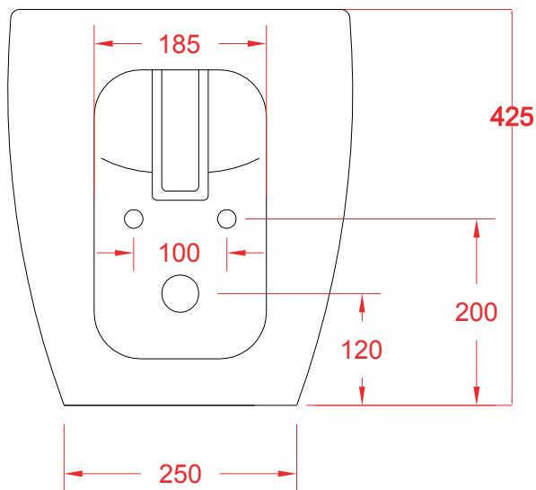
N.B. Le misure indicate possono subire una variazione dell'0,6% circa, dovuta ad usura stampi e a variazioni delle caratteristiche tecniche relative alle materie prime che compongono l'impasto.
