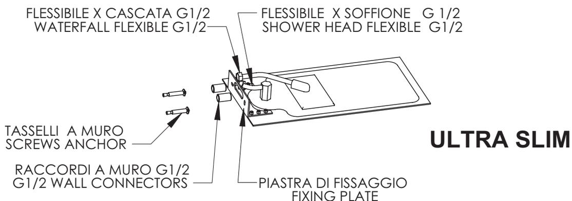
\* Per i soffioni con cascata, predisporre a muro 2 prese d'acqua miscelata da G1/2 in corrispondenza dei fori sulle piastre di fissaggio e inserire i 2 raccordi a muro G1/2. Installare un deviatore a monte per deviare l'acqua sulla cascata o sui getti. Per i soffioni senza cascata basta una presa a muro G1/2.
