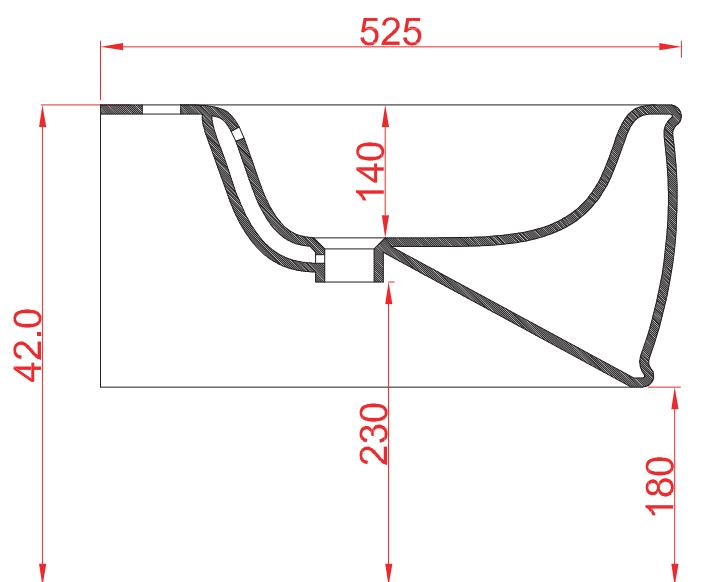
N.B. Le misure indicate possono subire una variazione dell'0,6% circa, dovuta ad usura stampi e a variazioni delle caratteristiche tecniche relative alle materie prime che compongono l'impasto .
